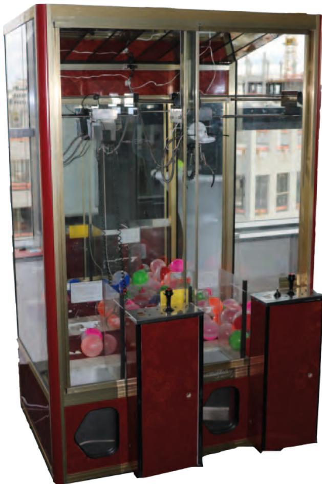
Damit Digital Engineering in seiner ganzen Komplexität verstanden wird, bedarf es praxisnaher Demonstratoren, die das Potenzial von IoT dem klassischen Maschinenbau näherbringen. Einen 25 Jahre alten Greifautomat mit IoT-Funktionen aus- und aufzurüsten dient der Software Factory als Prototyp, um Digitalisierung im wahrsten Sinne des Wortes „begreifbar“ zu machen. Mit Hilfe der IoT Plattform ThingWorx werden aktuelle Trends wie Predictive Maintenance veranschaulicht und erlebbar.
