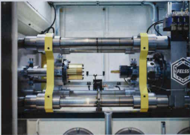
Bild 1: Wandaufdickung von Rohren: Mit Tube+ das Spektrum der Kaltumformung mittels AR neu definieren. (Bildquelle: Felss Systems)
